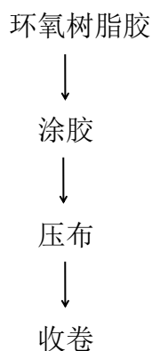
图 3-2 碳纤维预浸布生产工艺流程图
